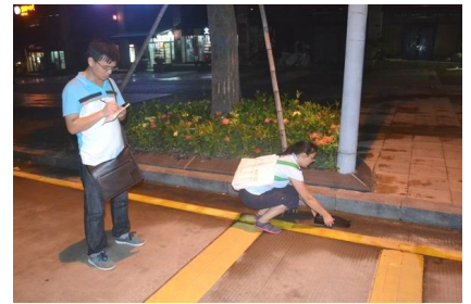
测量路灯光照度
