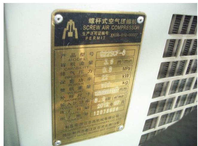
图左: 深圳市节能专家联合会工作人员现场核查汉华光电子公司购买节能空压机, 右: 空压机铭牌
